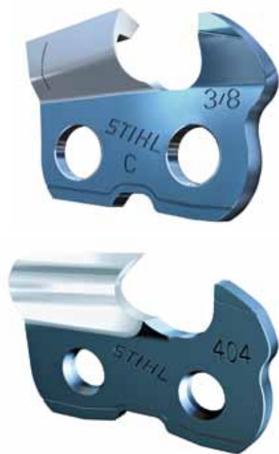
Ukázka řezacích zubů. Zaoblený profil zubu je určen pro sušší dřevo, zub s hranatým hřbetem je naopak účinnější při řezání vlhkého dřeva. Rysky naznačují možnou hranici opotřebení
