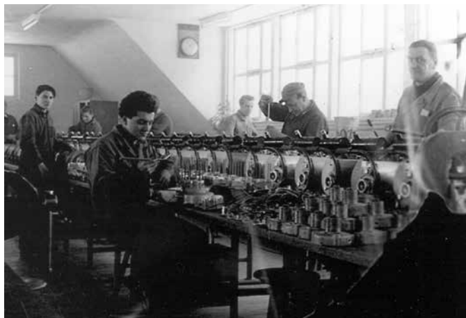
Nahoře: Montáž motorové pily typu BL – první jednomužné motorové pily na světě
